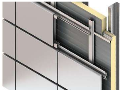
Rajah 8.0 – Pemasangan cladding pada fixed frame yang dipasang pada dinding.
